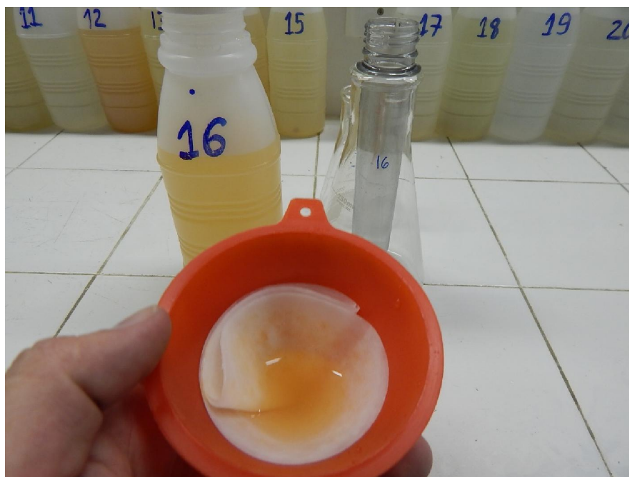
Figura 18 – Precipitados de ferro e manganês indicados pela coloração avermelhada da amostra de água durante a filtração, antes das análises no LABOMAR em Fortaleza -CE.
