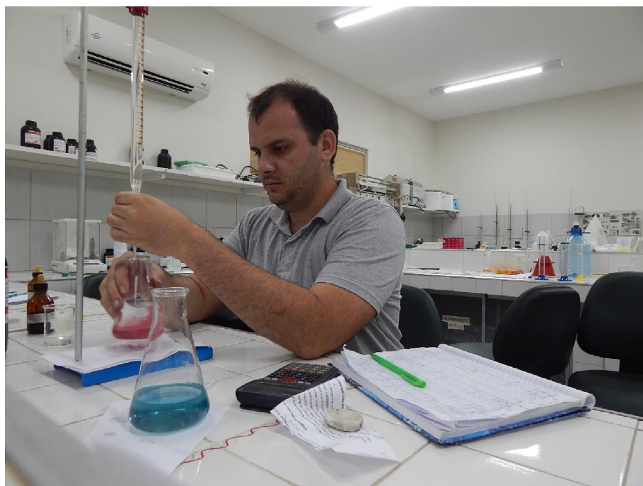
Figura 19 – Procedimento para a determinação da dureza total e das concentrações de cálcio e magnésio da água nas análises realizadas no IFCE de Morada Nova - CE.
