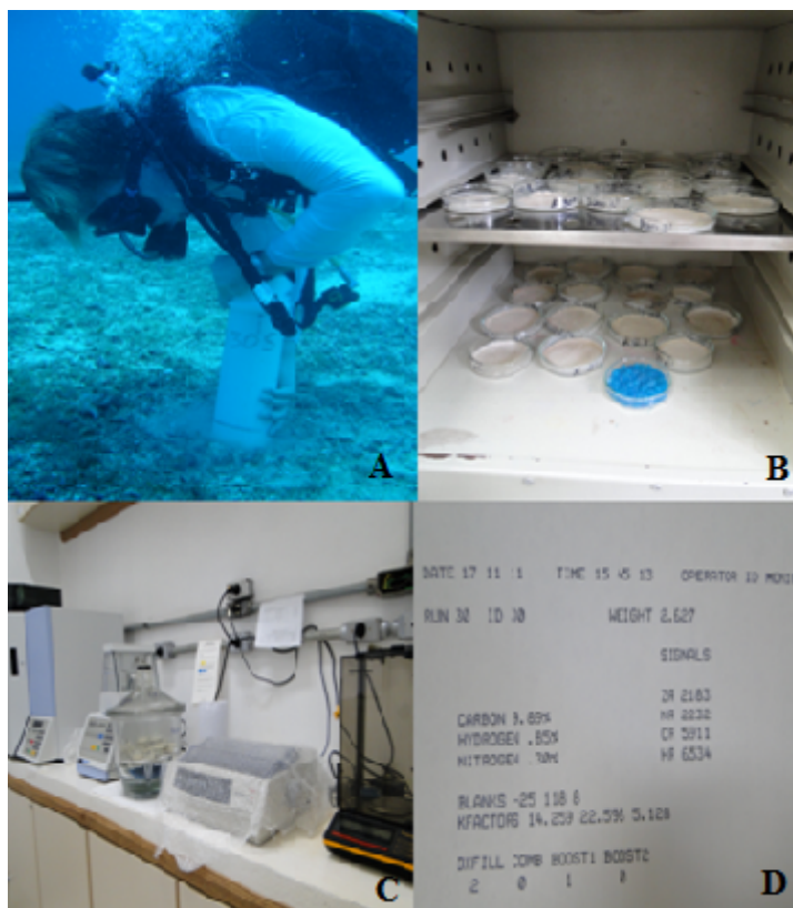
Figura 6: (A) Mergulhador coletando amostra de sedimento com auxílio de corer de PVC. (B) Amostras de sedimento, após descarbonatação, secando em estufa. (C) Equipamento CHNS/O. (D) Saída do equipamento com resultados das análises.
