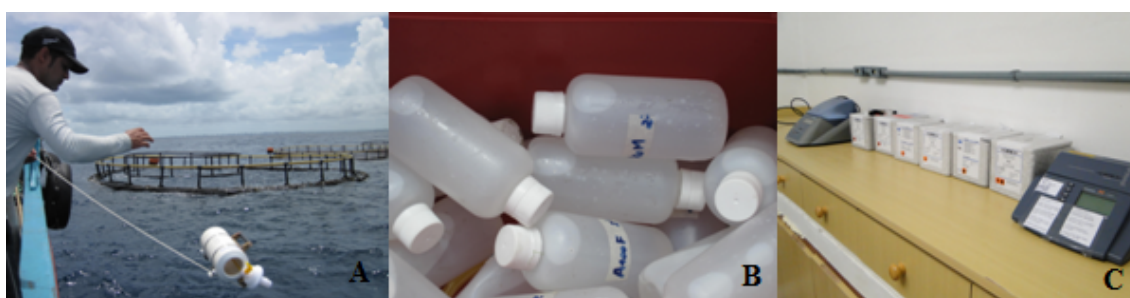
Figura 5: (A) Coleta de água com garrafa de Niskin. (B) Garrafas de água para análise de nutrientes. (C) Kits e aparelhos utilizados para determinação de nutrientes na água.
