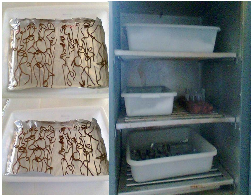
Figura 5 – Ração seca em estufa a 50°C.
